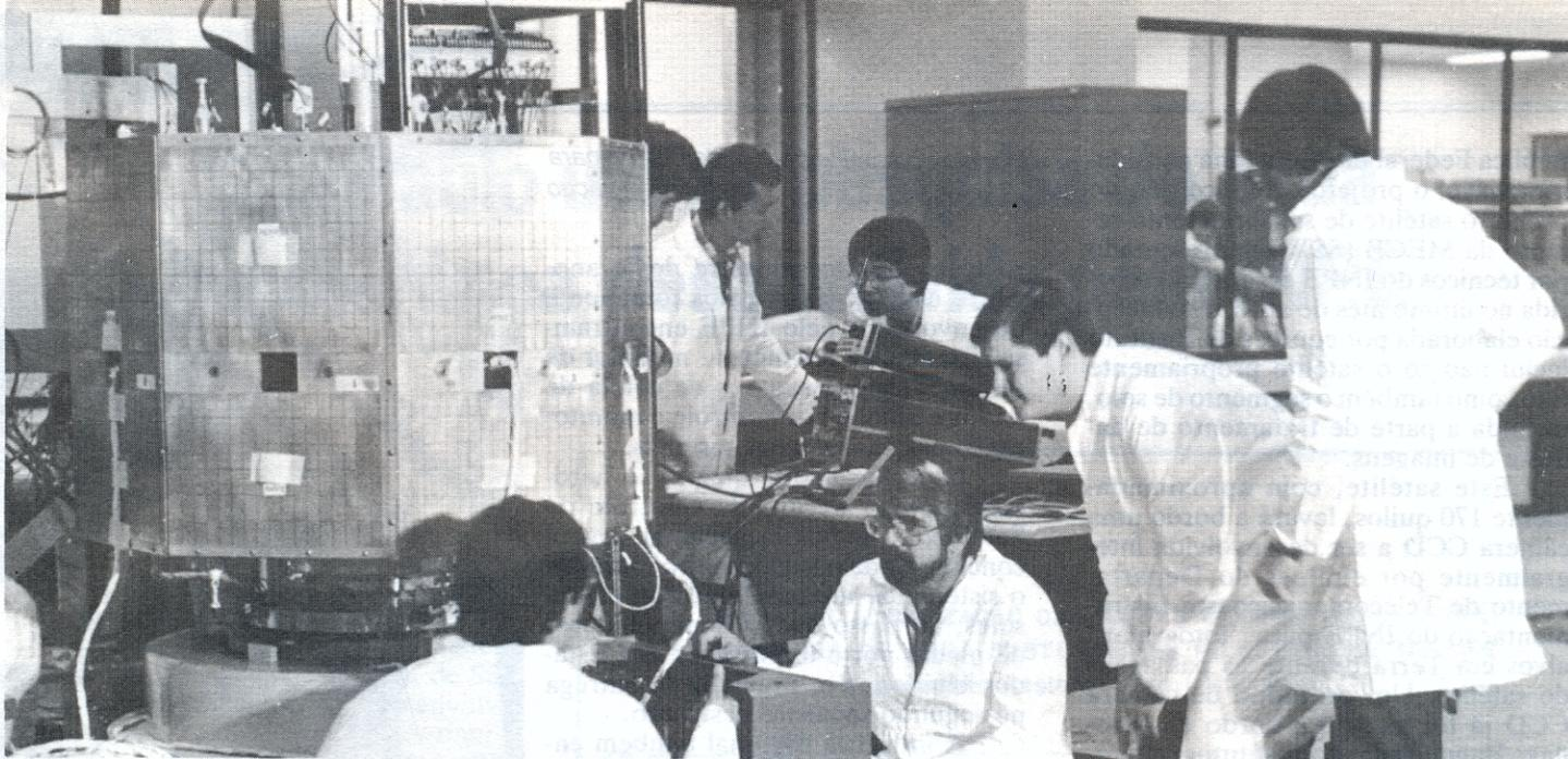
Modelo estrutural do satélite em teste de vibração
